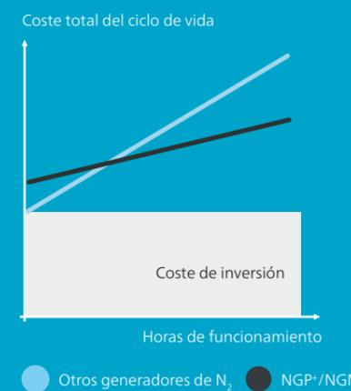
Con un factor de aire\* desde 1,8 (al 95 %) hasta 5,5 (al 99,999 %) y un algoritmo especial de modulación del tiempo de ciclo, el coste operativo del nuevo NGP+ puede reducirse hasta en un 50 % en comparación con otros generadores de N<sub>2</sub>.
